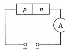
7. К полупроводнику р-п-типа подключен источник тока, как показано на. Будет ли амперметр регистрировать ток в цепи?
