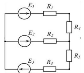
13. Определите токи через сопротивления, если  $R_1 = 2 \text{ Ом}$ ,  $R_2 = 6 \text{ Ом}$ ,  $R_3 = 10 \text{ Ом}$ ,  $E_1 = 20 \text{ В}$ ,  $E_2 = 12 \text{ В}$ .
