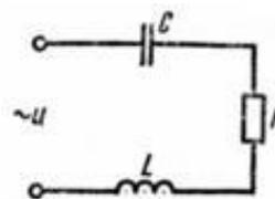
6.  $X_L = 10$  Ом;  $X_C = 5$  Ом. Как надо изменить емкость конденсатора, чтобы возник резонанс токов?
