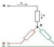
11. В трёхфазную сеть с линейным напряжением 220 В надо включить двигатель, обмотки которого рассчитаны на 127 В. Как следует соединить обмотки двигателя?
