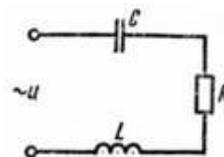
5.  $X_L = 20$  Ом;  $R = 10$  Ом;  $U = 10$  В. Найдите напряжение на конденсаторе при резонансе
