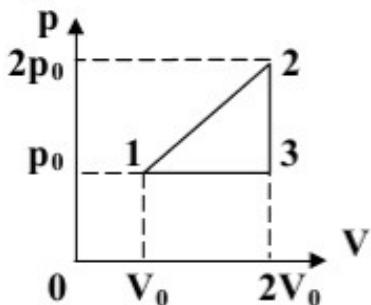
**18. Рассчитайте КПД тепловой машины использующей в качестве рабочего тела одноатомный газ и работающей по циклу, изображенному на графике.**
