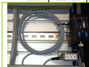
Подключите только провода 24V/0V к терминалу станции. Используйте кабельные наконечники. Не обрезайте провод (пусть останется кольцо). Подключите через датчик пневмошланг от компрессора.
