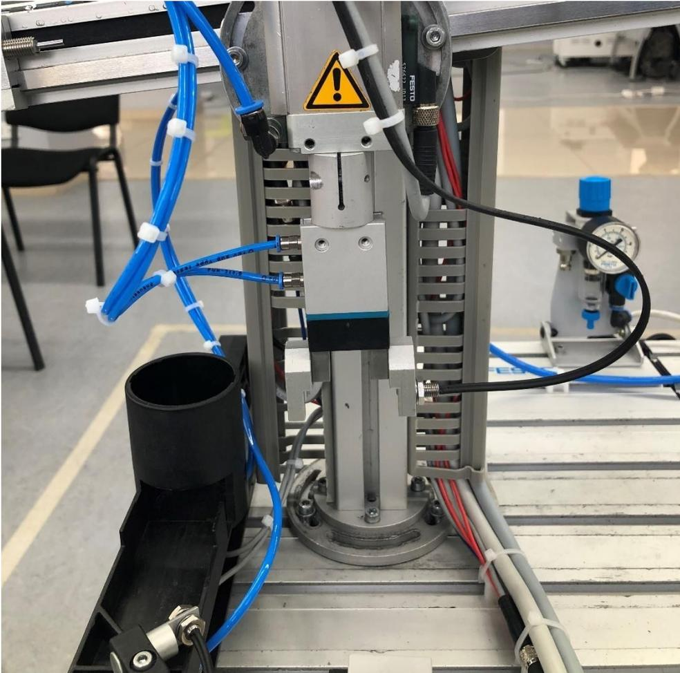
В захват монтируется оптоволоконно диффузионного датчика: «Деталь не черная». Захват необходимо расположить на шток ПЦ так, как показано на рисунке. Корпус датчика «деталь не черная» расположен на задней стороне вертикальной стойки.
