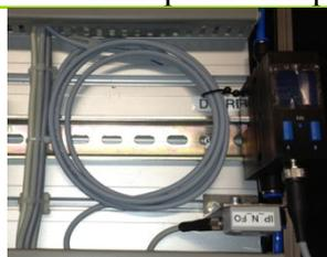
Подключите только провода 24V/0V к терминалу станции.
