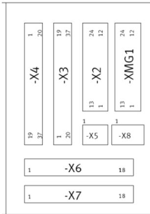
Разводка дополнительных сигналов к - X7 (клеммы 5-8 входы; клеммы 13-16 выходы)
