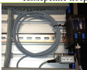
Подключите только провода 24V/0V к терминалу станции.
