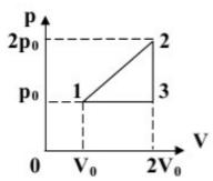
18. Рассчитайте КПД тепловой машины использующей в качестве рабочего тела одноатомный газ и работающий по циклу, изображенному на графике.
