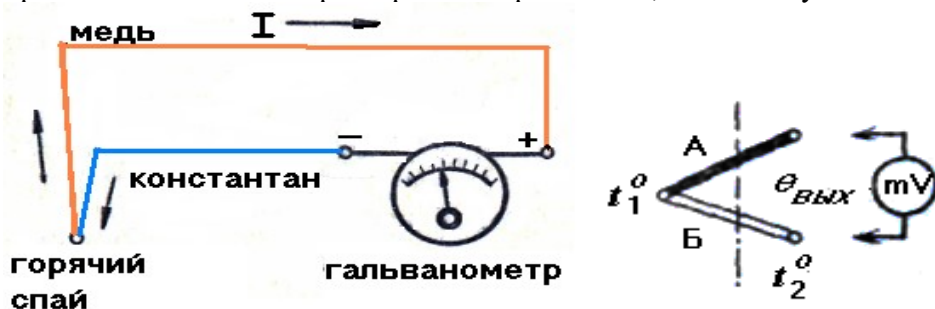
Рис. 3.2. Принцип действия термопары (а); его схема (б).
