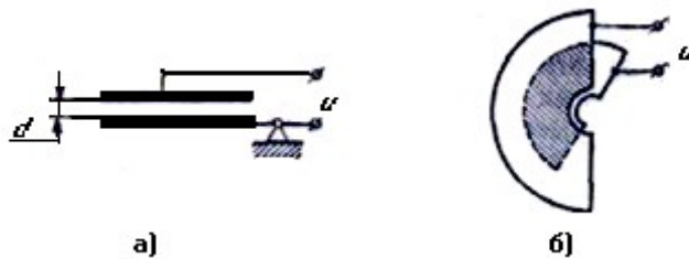
Рис. 3. 11 Принципиальные схемы емкостных датчиков: а — с поступательным перемещением пластин; б — поворотного типа.
