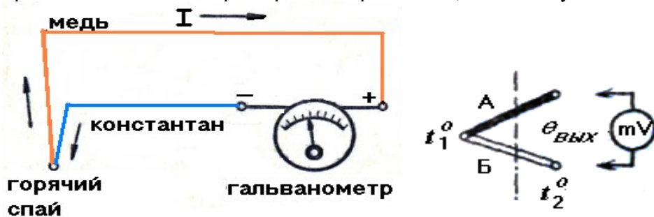
Рис. 3.2. Принцип действия термопары (а); его схема (б).
