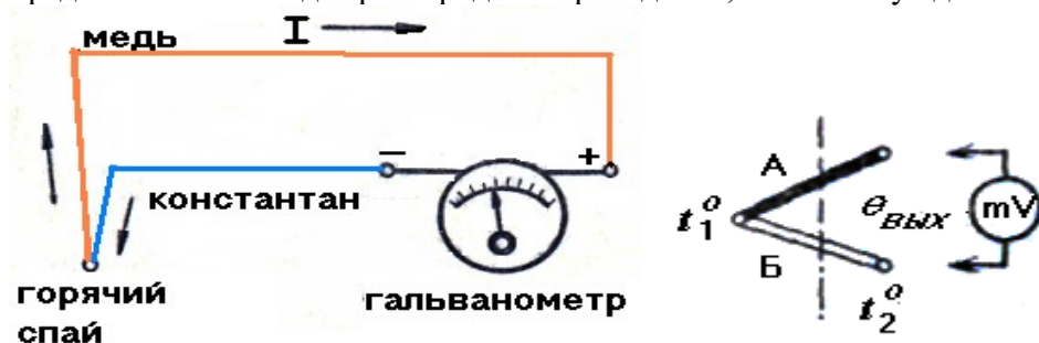
Рис. 3.2. Принцип действия термопары (а); его схема (б).
