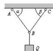
7. Определите направления и величины реакций связей для системы тел, если вес подвешенного тела составляет 10 кН.  $\alpha = 65^\circ$ ,  $\beta = 55^\circ$ .
