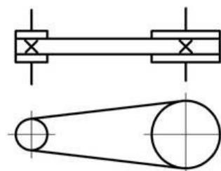
12. Для изображенной многоступенчатой передачи определить общее передаточное число, если  $d_1 = 50$  мм;  $d_2 = 200$  мм;  $d_3 = 35$  мм;  $d_4 = 70$  мм.
